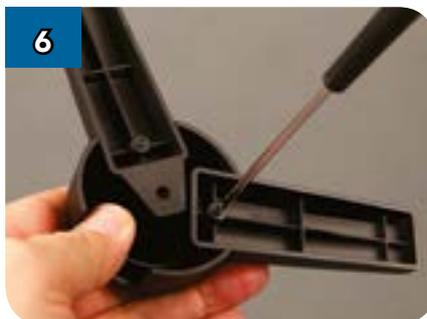
6 Вставьте винт в крепёжное отверстие и закрутите его до конца.
