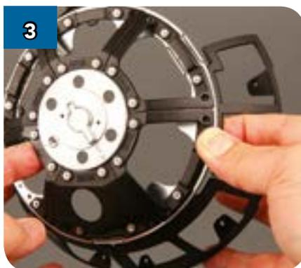
Плотно соедините деталь (DF-13) с готовой частью каркаса так, чтобы её установочные штифты вошли в соответствующие отверстия.
