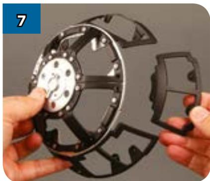
7 Совместите раму (DF-12) с каркасом так, чтобы крепёжные отверстия рамы и каркаса совпали (см. фотографию).
