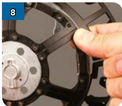
8 Плотно соедините деталь (DF-12) с готовой частью каркаса: её установочные штифты должны войти в соответствующие отверстия.
