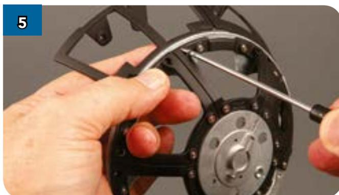
Фиксируя гайку пальцем, заверните в неё винт, вставив его в крепёжное отверстие в верхней части каркаса.
