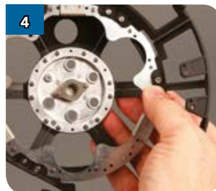
Удерживая раму (DF-13) на месте, установите гайку в шестиугольное гнездо над крепёжным отверстием.
