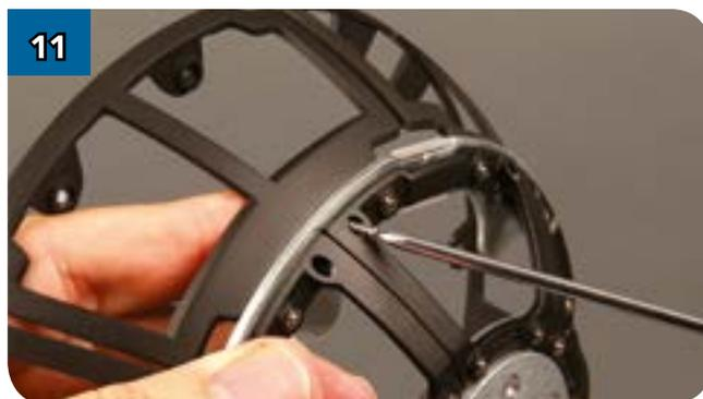
11 Повторите шаги 9 и 10 для того, чтобы закрепить деталь (DF-12) ещё одним винтом с гайкой.
