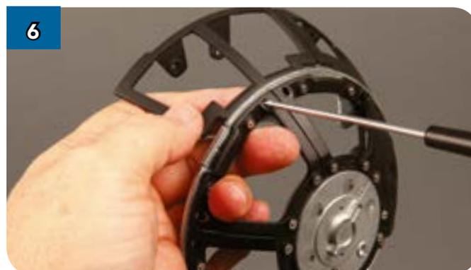
Повторите шаги 4 и 5, чтобы закрепить деталь (DF-13) ещё одним винтом с гайкой.
