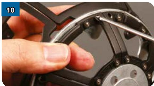
10 Фиксируя гайку пальцем, заверните в неё винт, вставив его в крепёжное отверстие в верхней части каркаса.
