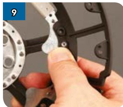
9 Удерживая раму (DF-12) на месте, установите гайку в шестиугольное гнездо над крепёжным отверстием.
